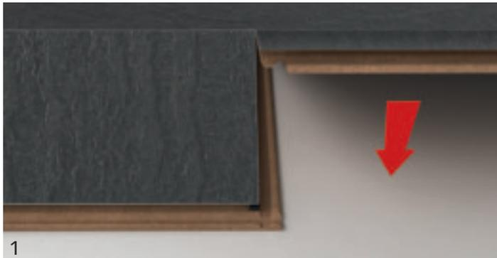
1 Der Boden wird kopfseitig dicht an der nebenliegenden Diele abgesenkt.
