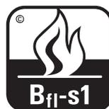
Die Materialien, die in Nadura-Böden verarbeitet werden, sind schwer entflammbar und sichern den Produkten die Brandschutzklasse B<sub>fl</sub>-s1.
