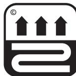
Nadura-Böden eignen sich auch zur Verlegung auf Untergründen mit kontrollierter Warmwasser-Fußbodenheizung.
